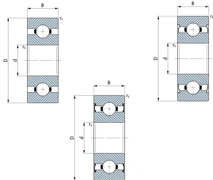
**Rostfreie Miniatur-Rillenkugellagern (Kugellager mit einem Bohrungsdurchmesser < 10 mm werden der Gruppe „Miniaturlager“ zugeordnet) finden in unterschiedlichen Einsatzgebieten Anwendung, wo die Gefahr von Korrosionsbildung besteht.**
