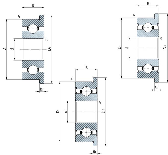
**Rostfreie Miniatur-Rillenkugellagern mit Flansch am Außenring (Kugellager mit einem Bohrungsdurchmesser < 10 mm werden der Gruppe „Miniaturlager“ zugeordnet) finden in unterschiedlichen Einsatzgebieten Anwendung, wo die Gefahr von Korrosionsbildung besteht.**
