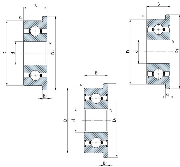
Die einreihigen Miniatur-Rillenkugellagern mit Flansch rostfrei in zölligen Abmessungen (Kugellager mit einem Bohrungsdurchmesser < 10 mm werden der Gruppe „Miniaturlager“ zugeordnet) finden in unterschiedlichen Einsatzgebieten Anwendung, wo die Gefahr von Korrosionsbildung besteht.
