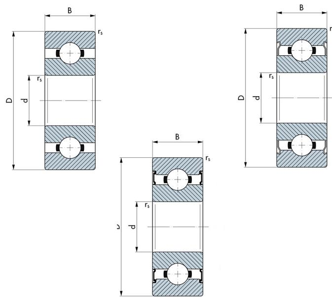
**Rostfreie Miniatur-Rillenkugellagern in zölligen Abmessungen (Kugellager mit einem Bohrungsdurchmesser < 10 mm werden der Gruppe „Miniaturlager“ zugeordnet) finden in unterschiedlichen Einsatzgebieten Anwendung, wo die Gefahr von Korrosionsbildung besteht.**
