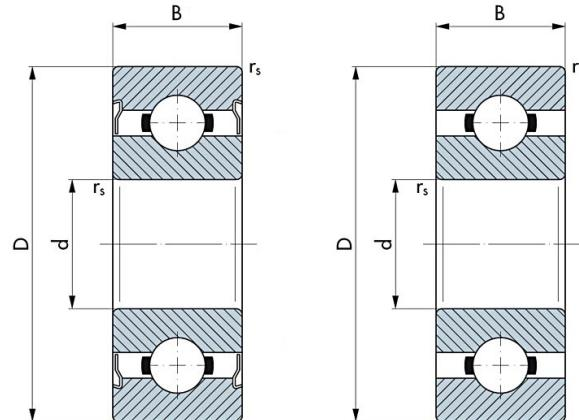
**HNS-Miniaturlager (Kugellager mit einem Bohrungsdurchmesser < 10 mm werden der Gruppe „Miniaturlager“ zugeordnet) finden in unterschiedlichen Einsatzgebieten Anwendung, wo die Gefahr von Korrosionsbildung besteht.**
